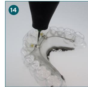
Schiene vom Modell abheben und Sägeschnitte zwischen den Schrauben mit dem HM-Tricutter fein (grün) ausdehnen/verbinden.
