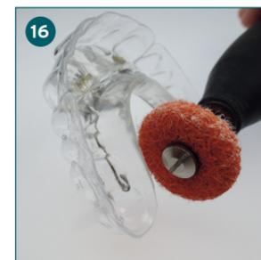
Wir empfehlen für die finale Randbearbeitung eine zugerichtete DIMO® PRO (siehe Abb.) und den SD-Hochglanzschwabbel in Verbindung mit der SD-Polierpaste A. Achten Sie auf eine niedrige Drehzahl (5.000 - 10.000 U/m)
