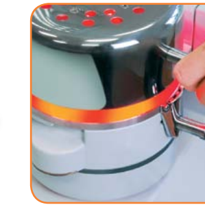
Strahler nach ca. 1 Minute Aufheizen über die Folie schwenken.
