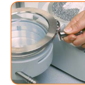
Strahler aktivieren, Folie einspannen und verriegeln.
