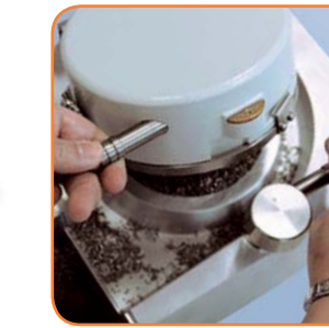
Nach Ablauf der Heizzeit Druckkammer bzw. Plattenträger über das Modell schwenken und verschließen.
