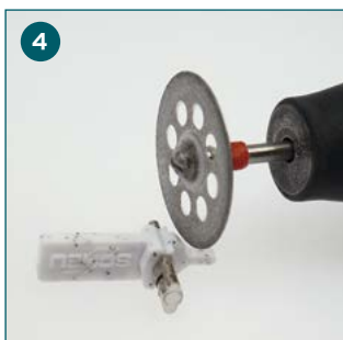
Den unteren Teil des Platzhalters der Spezialzugschraube mit der Diamanttrennscheibe kürzen.
