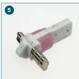
Um den Platzhalter der Spezial- zugschraube später besser entfernen zu können, empfehlen wir diesen mit Wachs zu verbreitern.
